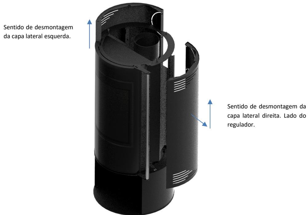
Figura 17 - Desmontagem das capas laterais no equipamento
