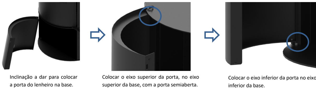
Figura 12 - Colocação da porta na base/lenheiro do equipamento
